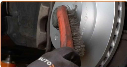
**26** Appliquez du produit sur la zone de contact entre le disque de frein et la jante. Utilisez du lubrifiant céramique.
