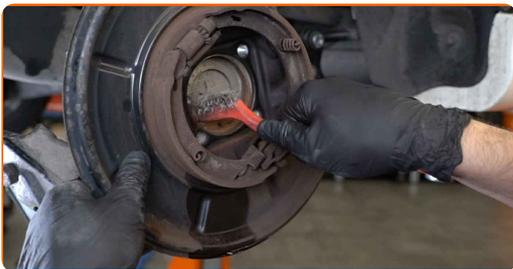
**23** Installez le nouveau moyeu de roue avec un roulement.
