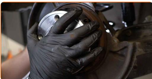
**24** Serrez la fixation du palier de moyeu de roue. Utilisez une douille n° E16. Utilisez une clé dynamométrique. Serrez-le jusqu'à 120 Nm.
