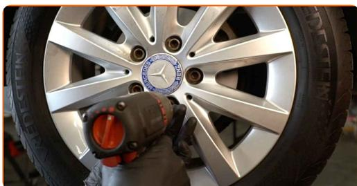
**39** Abaissez la voiture et serrez les boulons de roue en ordre croisé. Servez-vous d'une douille à choc pour roue N°H12. Utilisez une clé dynamométrique. Serrez-le jusqu'à 130 Nm.
