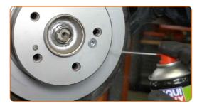
Appliquez du produit sur la zone de contact entre le disque de frein et la jante. Utilisez du lubrifiant céramique.
