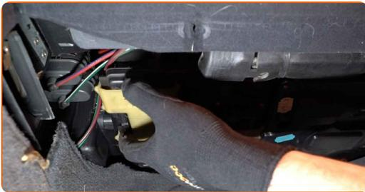
6 Retirez les filtres à air recyclé pour l'habitacle du boîtier du climatiseur.
