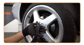
Abaissez la voiture et serrez les boulons de roue en ordre croisé. Utilisez une clé dynamométrique. Serrez-le jusqu'à 110 Nm.
