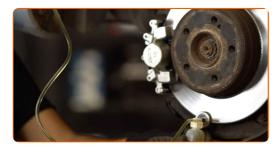
Nettoyez la surface du disque de frein. Utilisez une brosse métallique. Traitez la surface de contact. Utilisez de la graisse au cuivre.
