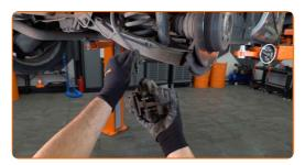
Remplacement : étrier de frein – MERCEDES-BENZ Classe C Break (S203). Les experts d'AUTODOC recommandent :
