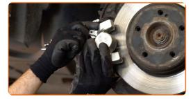
Serrez les fixations de l'étrier de frein. Utilisez une douille n° 16. Utilisez une clé dynamométrique. Serrez-le jusqu'à 55 Nm.
