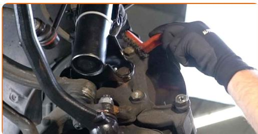
**14** Dévissez l'attache du support d'étrier. Utilisez une douille n° 18. Utilisez un porte-taraud. Utilisez une clé à cliquet.
