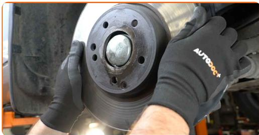
**19** Nettoyez le moyeu. Utilisez une brosse métallique. Traitez la surface de contact. Utilisez de la graisse au cuivre.
