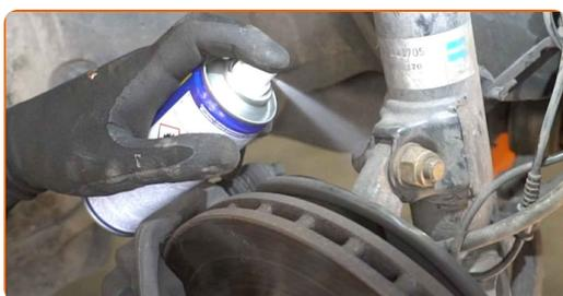
**17** Dévissez la fixation supérieure reliant la jambe de suspension à la fusée d'essieu. Utilisez la clé HEX n° H12. Utilisez une douille n° 21. Utilisez une clé à cliquet. Utilisez un porte-taraud.
