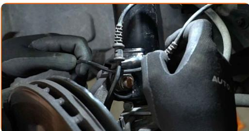
**61** Connectez le câble du capteur d'usure de plaquette de frein.
