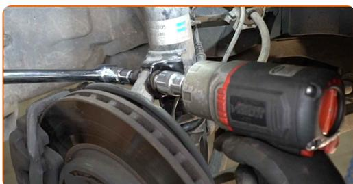
**18** Nettoyez les fixations assurant la connexion entre la jambe d'amortisseur et le porte-fusée. Utilisez une brosse métallique. Servez vous de l'aérosol WD-40.
