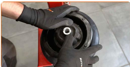
**42** Serrez l'écrou de l'entretoise d'amortisseur due la tige de piston. Utilisez une douille pour ecrou de jambe de suspension de 14X2.5 mm. Utilisez une douille n° 21. Utilisez la clé HEX n° H6. Utilisez une clé dynamométrique. Serrez-le jusqu'à 20 Nm.
