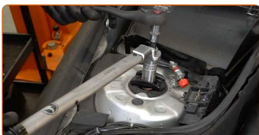
**73** Lubrifiez les fixations de la coupelle d'amortisseur. Utilisez de la graisse au cuivre.
