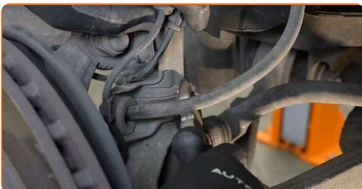
**14** Débranchez les fils du capteur d'ABS.
