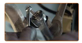
Dévissez la fixation reliant la biellette à l'amortisseur. Utilisez une douille n° 18. Utilisez une clé à cliquet.
