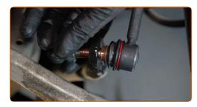
Serrez la fixation reliant la biellette à la barre stabilisatrice. Utilisez une douille n° 19. Utilisez une clé dynamométrique. Serrez-le jusqu'à 98 Nm.
