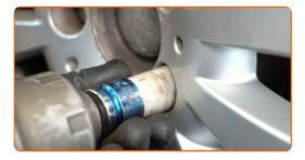
Abaissez la voiture et serrez les boulons de roue en ordre croisé. Servez-vous d'une douille à choc pour roue N°17. Utilisez une clé dynamométrique. Serrez-le jusqu'à 130 Nm.
