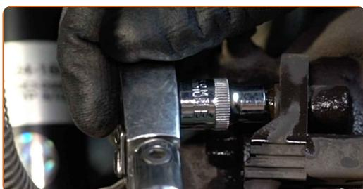
**10** Retirez l'écrou de fixation.
