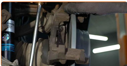
**35** Installez les boulons de fixation.
