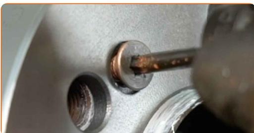
**31** Serrez l'attache du disque de frein. Utilisez la mèche Torx T30. Utilisez une clé dynamométrique. Serrez-le jusqu'à 10 Nm.
