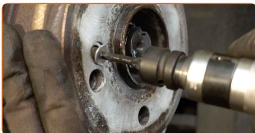
**24** Retirez l'écrou de fixation.
