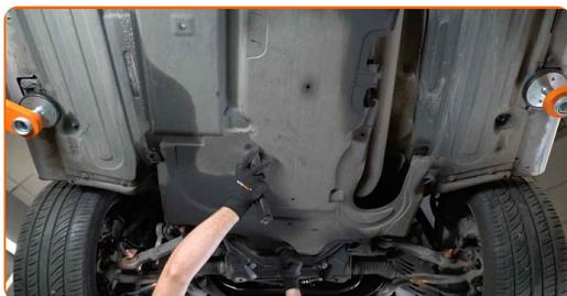
**24** Serrez les fixations du carénage sous moteur. Utilisez une douille n° 10. Utilisez une clé à cliquet.
