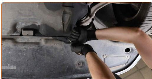
**8** Retirez le carénage sous moteur.
