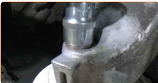
**22** Serrez la fixation supérieure du support moteur. Utilisez une douille n° 16. Utilisez une clé dynamométrique. Serrez-le jusqu'à 50 Nm.
