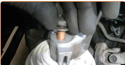
**21** Vissez la fixation supérieure du support du moteur. Utilisez une douille n° 16. Utilisez une clé à cliquet.
