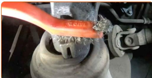
**4** Dévissez la fixation supérieure du support moteur. Utilisez une douille n° 16. Utilisez une clé à cliquet.
