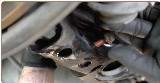
**25** Vissez la fixation inférieure de l'amortisseur. Utilisez une clé mixte de No.16 Utilisez une douille n° 16. Utilisez une clé à cliquet.
