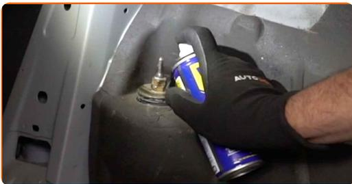
**10** Dévissez l'attache supérieure de l'amortisseur. Utilisez une clé mixte de No.17 Servez-vous d'un embout d'amortisseur n°DD6. Utilisez une clé à cliquet.
