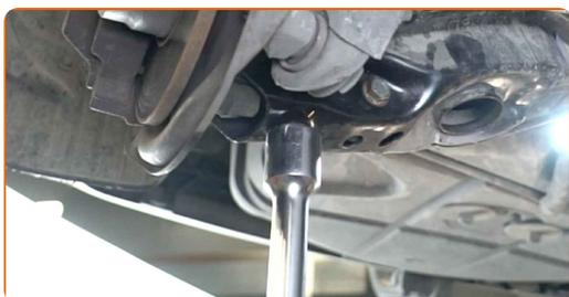
**27** Serrez l'attache inférieure de l'amortisseur. Utilisez une clé mixte de No.16 Utilisez une douille n° 16. Utilisez une clé dynamométrique. Serrez-le jusqu'à 55 Nm.
