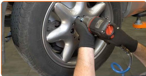
**36** Abaissez la voiture et serrez les boulons de roue en ordre croisé. Servez-vous d'une douille à choc pour roue N°17. Utilisez une clé dynamométrique. Serrez-le jusqu'à 110 Nm.
