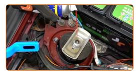
Desserrez les fixations du support de jambe de suspension supérieur. Utilisez une douille n° 13. Utilisez une clé à cliquet.
