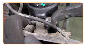
Serrez les fixations inférieures sur les amortisseurs. Utilisez une douille n° 19. Utilisez une clé dynamométrique. Serrez-le jusqu'à 110 Nm.
