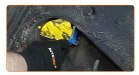
Nettoyez le siège de montage du support de jambe de suspension. Utilisez une brosse métallique. Servez-vous d'un aérosol nettoyant multi-usages.
