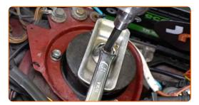
Remplacement : jambe de suspension – MERCEDES-BENZ Classe E Break (S124). Conseil :
