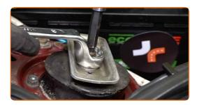
Dévissez les fixations du support supérieur de jambe de suspension. Utilisez une douille n° 13. Utilisez une clé à cliquet.
