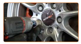
Abaissez la voiture et serrez les boulons de roue en ordre croisé. Servez-vous d'une douille à choc pour roue N°17. Utilisez une clé dynamométrique. Serrez-le jusqu'à 110 Nm.
