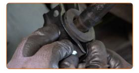
25 Installez les boulons de fixation.
