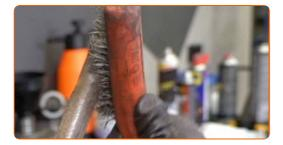
Installez les nouvelles silentblocs de barre stabilisatrice.
