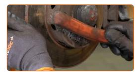
Appliquez du produit sur la surface où le disque de frein entre en contact avec la jante. Utilisez du lubrifiant céramique.
