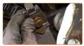
Nettoyez les emplacements de montage des silentblocs de barre stabilisatrice. Utilisez une brosse métallique. Servez-vous d'un aérosol nettoyant multi-usages.
