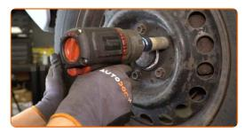
Abaissez la voiture et serrez les boulons de roue en ordre croisé. Servez-vous d'une douille à choc pour roue 31 N°17. Utilisez une clé dynamométrique. Serrez-le jusqu'à 110 Nm.
