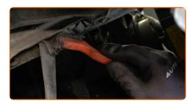
Dévissez les fixations des supports de la barre stabilisatrice. Utilisez une douille n° 17. Utilisez une clé à cliquet.
