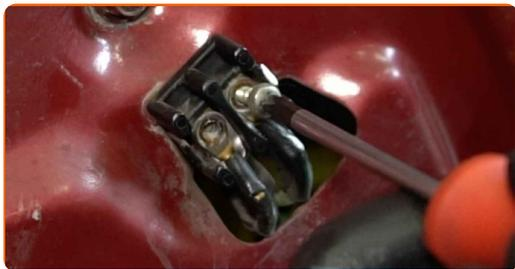
**15** Dévissez les fixations du mécanisme de lève-vitre. Utilisez une douille n° 10. Utilisez une clé à cliquet.
