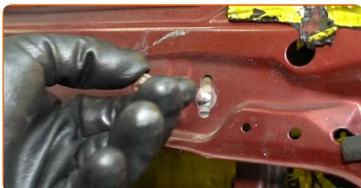
**17** Retirez le mécanisme de lève-vitre.
