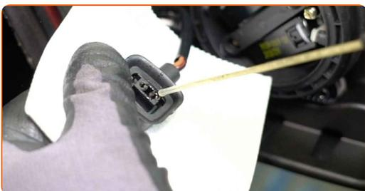
**7** Réinstallez le connecteur du chauffage de rétroviseur.
