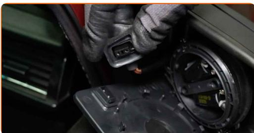
**6** Appliquez du produit sur le connecteur du chauffage de miroir. Utilisez de la graisse diélectrique.
