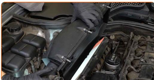
**8** Retirez l'élément filtrant du compartiment du filtre.
