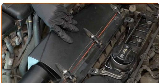
**14** Vissez les trois vis de fixation du couvercle de filtre à air. Utilisez une douille n° E11. Utilisez une clé à cliquet.
