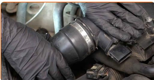
**16** Vissez le collier de fixation reliant le conduit d'air au boîtier de filtre à air. Utilisez une douille n° 7. Utilisez une clé à cliquet.
