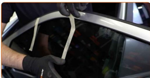
**37** Abaissez la vitre de la fenêtre et installez-la sur son emplacement de montage dans le mécanisme de lève-vitre.
