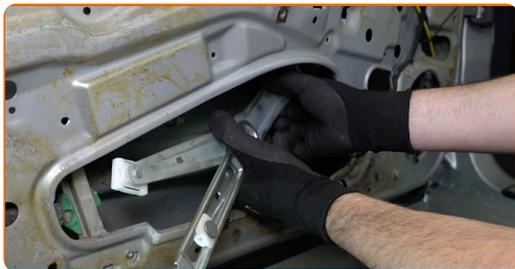
**34** Appliquez du produit sur le mécanisme du lève-vitre. Utilisez une graisse au lithium multiusage.
