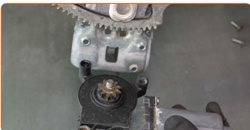
**31** Installez et vissez les fixations du moteur sur le nouveau mécanisme de lève-vitre. Utilisez la mèche Torx T30. Utilisez une clé à cliquet.
