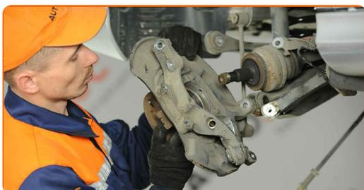
Remplacement : roulement de roue – MERCEDES-BENZ Classe E Break (S211). AUTODOC recommande :
