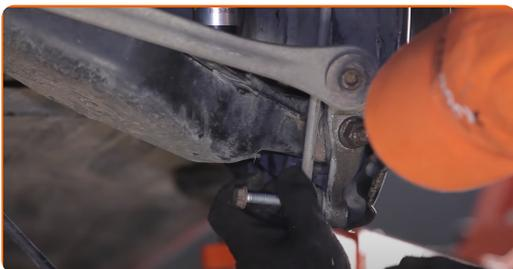
**77** Resserez la fixation de la biellette de la barre stabilisatrice. Utilisez une clé mixte de No.16 Utilisez une douille n° 16. Utilisez une clé dynamométrique. Serrez-le jusqu'à 50 Nm.
