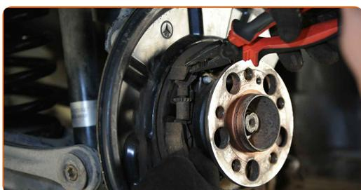
**81** Installez l'écrou de fixation.
