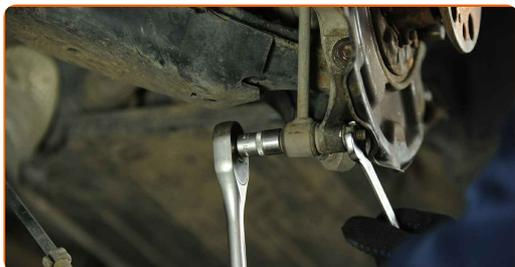
**25** Retirez l'écrou de fixation.
