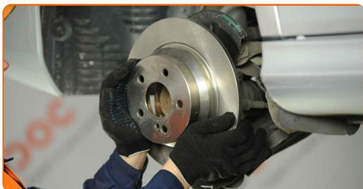
**13** Dessertissez l'écrou de retenue du moyeu de roue. Servez-vous d'un burin plat pour l'usinage des métaux. Servez-vous d'un marteau.
