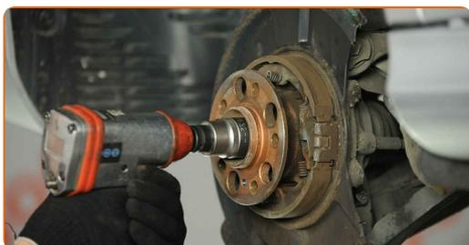
**15** Retirez l'écrou de fixation.
