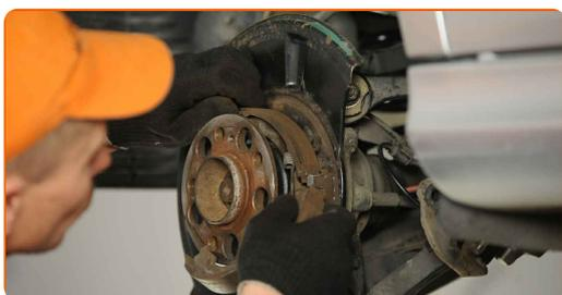
**80** Insérez le mécanisme de réglage des mâchoires de frein. Utilisez des pinces. Servez-vous de pinces à bout rond. Utilisez un tournevis plat.
