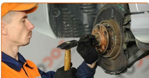
**14** Dévissez l'écrou de l'axe de moyeu de roue. Utilisez une douille n° 32. Utilisez une clé à cliquet.
