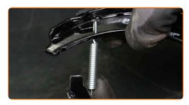
Installez le dispositif de réglage du frein de stationnement.
