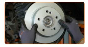
37 Installez l'écrou de fixation.
