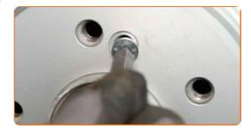
Serrez les fixations du disque de frein. Utilisez la clé HEX n° H5. Utilisez une clé dynamométrique. Serrez-le jusqu'à 10 Nm.
