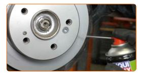
Appliquez du produit sur la zone de contact entre le disque de frein et la jante. Utilisez du lubrifiant céramique.
