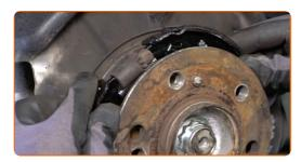
Installez les ressorts de maintien des mâchoires de frein de stationnement. Utilisez des pinces à bec long.
