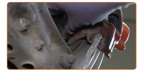
Serrez les fixations de l'étrier de frein. Utilisez une douille n° 17. Utilisez une clé dynamométrique. Serrez-le jusqu'à 65 Nm.
