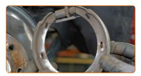
Nettoyez les sièges de montage des mâchoires de frein de stationnement. Utilisez une brosse métallique. Servezvous d'un aérosol nettoyant multi-usages.
