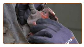
41 Installez les boulons de fixation.
