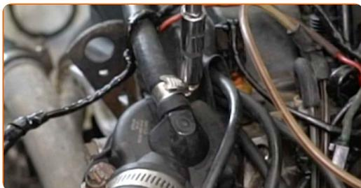
**10** Détachez le tuyau du vase d'expansion du boîtier du thermostat.
