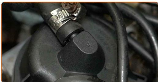
**24** Serrez le collier de serrage du flexible du vase d'expansion. Utilisez une douille n° 7. Utilisez une clé à cliquet.
