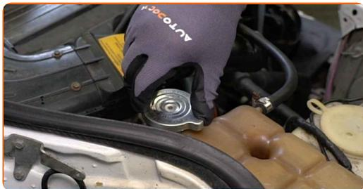
**29** Vissez le bouchon du réservoir de liquide de refroidissement.
