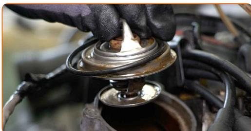
Remplacement : calorstat – MERCEDES-BENZ Classe E Cabriolet (A124). Les professionnels recommandent :
