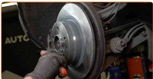
**34** Appliquez du produit sur la zone de contact entre le disque de frein et la jante. Utilisez du lubrifiant céramique.
