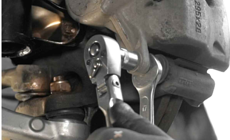
11 Retirez les écrous de fixations.
