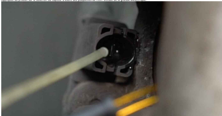
24 Branchez le connecteur du capteur d'usure de plaquette de frein.
