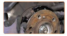
Installez les ressorts de maintien des mâchoires de frein de stationnement. Utilisez des pinces à bec long.
