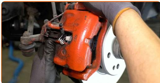
**37** Installez les boulons de fixation.
