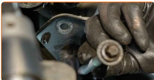
**16** Dévissez la fixation reliant le bras de commande au sous-châssis. Utilisez une clé mixte de No.18 Servez vous de la douille XZN n°12. Utilisez une clé à cliquet.
