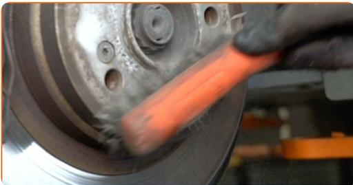
**37** Appliquez du produit sur la zone de contact entre le disque de frein et la jante. Utilisez du lubrifiant céramique.
