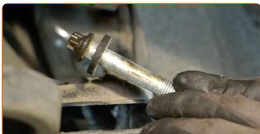
**15** Retirez la plaque d'arrêt de cadre auxiliaire.
