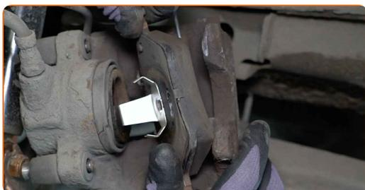
Remplacement : plaquettes de frein – MERCEDES-BENZ Classe E Camion à Plateau / Châssis (VF210). AUTODOC recommande :
