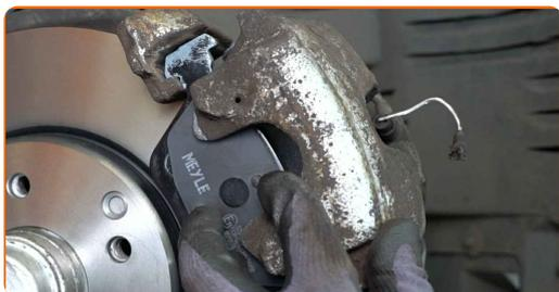
**21** Serrez les fixations de l'étrier de frein. Utilisez la clé HEX n° H7. Utilisez une clé dynamométrique. Serrez-le jusqu'à 25 Nm.
