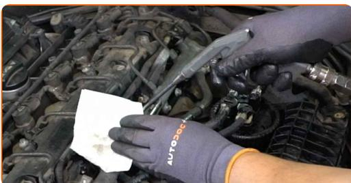
**12** Dévissez les bougies de préchauffage. Servez-vous de la douille de bougie d'allumage n°10. Utilisez une clé dynamométrique.
