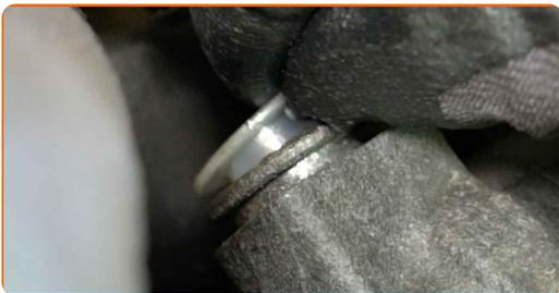
**10** Débranchez les connecteurs de câblage des bougies de préchauffage. Utilisez des pinces à bec long.
