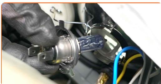
**10** Détachez le support de l'ampoule du feu clignotant en le tournant d'environ 30°.
