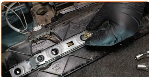
30 Installez la douille en même temps que les ampoules.
