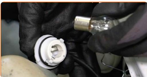
**12** Appliquez du produit sur les connecteurs des ampoules. Utilisez de la graisse diélectrique.
