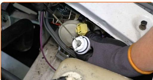
**13** Installez une nouvelle ampoule de feu clignotant dans la douille.
