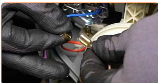
**5** Écartez le dispositif de retenue de l'ampoule du feu de brouillard.
