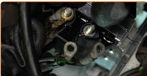
**16** Appliquez du produit sur les bornes de la bobine d'allumage. Utilisez de la graisse diélectrique.
