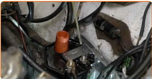
**17** Vissez les bornes de la bobine d'allumage. Utilisez une douille n° 10. Utilisez une clé à cliquet.
