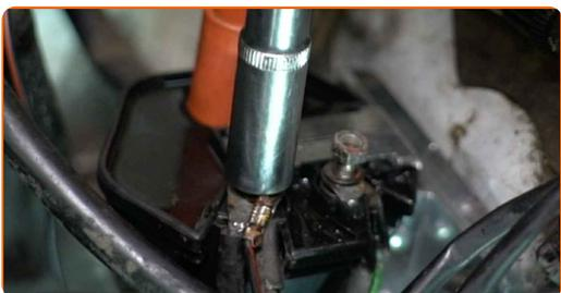
**18** Connectez le câble haute tension à la bobine d'allumage.
