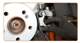
Connectez le capteur d'usure des plaquettes de frein.
