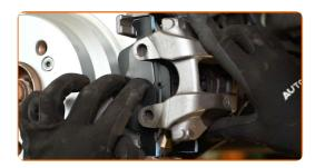
Installez les bouchons anti-poussière des goupilles de guidage de l'étrier de frein.
