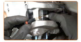
Connectez le connecteur du capteur d'usure de la plaquette de frein.
