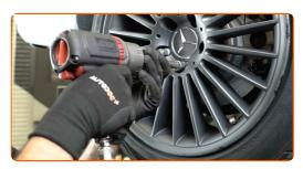
Abaissez la voiture et serrez les boulons de roue en ordre croisé. Servez-vous d'une douille à choc pour roue N°17. Utilisez une clé dynamométrique. Serrez-le jusqu'à 130 Nm.
