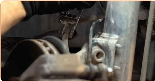
**11** Desserrez l'attache du flexible de frein. Utilisez une clé polygonale ouverte #14.
