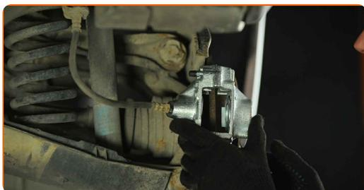
**21** Appliquez du produit sur les boulons de serrage. Utilisez un enduit.
