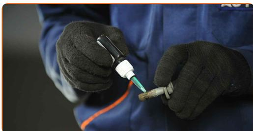
**22** Installez les boulons de fixation (2 pièces).
