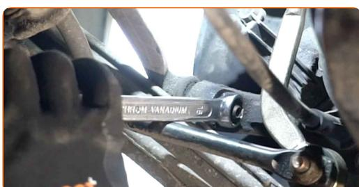
**13** Détachez le joint à rotule de la fusée arrière. Servez-vous d'un extracteur de rotules.
