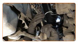
Remplacement : biellette de barre stabilisatrice – MERCEDES-BENZ CLK Décapotable (A209). Conseil d'AUTODOC :
