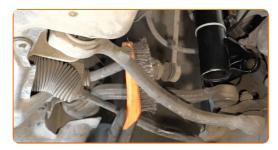
Dévissez la fixation reliant la biellette à l'amortisseur. Utilisez une douille n° 16. Utilisez une clé à cliquet.
