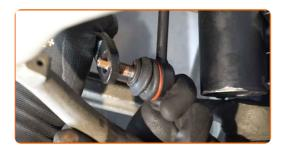
Serrez la fixation reliant la biellette à l'amortisseur. Utilisez une douille n° 17. Utilisez une clé dynamométrique. Serrez-le jusqu'à 60 Nm.
