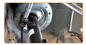
Serrez la fixation reliant la biellette à la barre stabilisatrice. Utilisez une douille n° 17. Utilisez une clé dynamométrique. Serrez-le jusqu'à 60 Nm.
