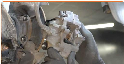
Remplacement : disques de frein – MERCEDES-BENZ CLK Décapotable (A209). Les professionnels recommandent :
