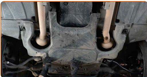
**27** Serrez les fixations du carénage sous moteur. Utilisez une douille n° 8. Utilisez une clé à cliquet.
