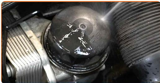
**12** Dévissez le bouchon du compartiment du filtre, ainsi que l'ancien élément filtrant. Utilisez la douille 74/15F. Utilisez une clé à cliquet.
