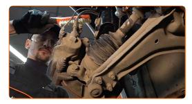
Dévissez l'attache de l'étrier de frein. Utilisez la mèche Torx T40. Utilisez une clé à cliquet.
