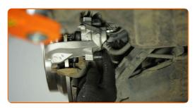
Serrez la fixation reliant la conduite de freinage à l'étrier de frein. Utilisez une clé polygonale ouverte #14. Utilisez une clé dynamométrique. Serrez-le jusqu'à 18 Nm.
