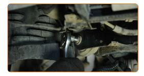
11 Retirez l'écrou de fixation.
