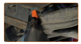
Dévissez l'attache du bras de la sous-structure. Utilisez une clé mixte de No.21. Utilisez une douille n° E18. Utilisez une clé à cliquet.
