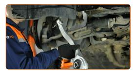
Remplacement : bras inférieur avant – MERCEDES-BENZ CLS Coupe (C219). Les professionnels recommandent :
