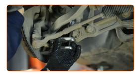
Nettoyez les fixations reliant le bras de commande au sous-châssis. Utilisez une brosse métallique. Servez vous de l'aérosol WD-40.
