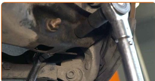
**16** Serrez la fixation reliant la biellette à la barre stabilisatrice. Utilisez une clé mixte de No.17 Utilisez une clé mixte de No.22 Utilisez une clé dynamométrique. Serrez-le jusqu'à 50 Nm.
