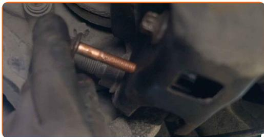
**15** Serrez la fixation qui relie la biellette de barre stabilisatrice au bras de suspension. Utilisez une douille n° 13. Utilisez la mèche Torx E12. Utilisez une clé dynamométrique. Serrez-le jusqu'à 20 Nm.+180°
