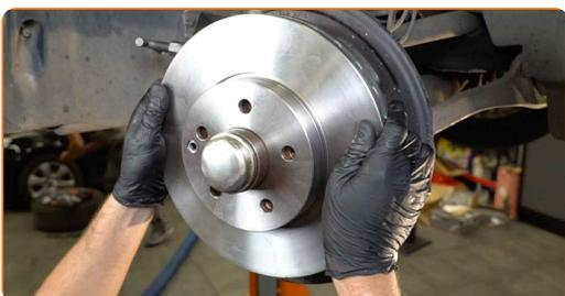
**53** Serrez l'attache du disque de frein. Utilisez la mèche Torx T30. Utilisez une clé dynamométrique. Serrez-le jusqu'à 8 Nm.
