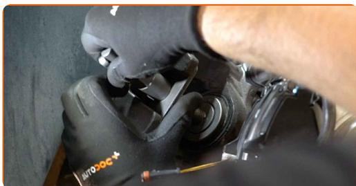
**60** Installez l'étrier de frein et fixez-le. Utilisez une clé mixte de No.17. Utilisez une douille n° 13. Utilisez une clé dynamométrique. Serrez-le jusqu'à 35 Nm.
