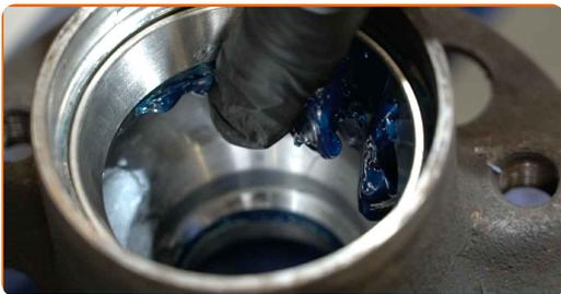
**41** Installez un nouveau roulement de moyeu de roue.
