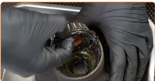
**33** Nettoyez l'emplacement de roulement de moyeu.
