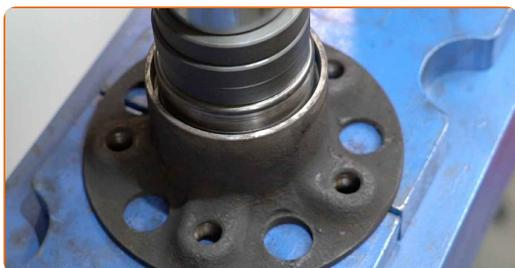
**40** Appliquez du produit sur le siège de fixation de l'ensemble de roulement. Servez-vous d'une graisse multi-usages.
