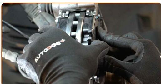
**58** Connectez le capteur d'usure des plaquettes de frein.
