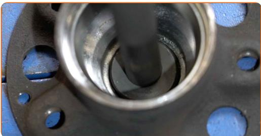
**35** Tirez la bague de roulement intérieure du moyeu de roue. Servez-vous d'un extracteur d'engrenage à 3 bras. Utilisez un coffret de douilles et de roulements.
