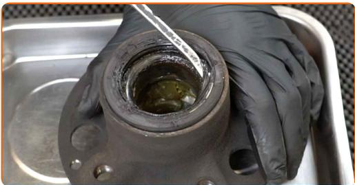
**32** Retirez le roulement du moyeu de la roue.
