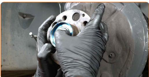
**48** Installez l'écrou de fixation.
