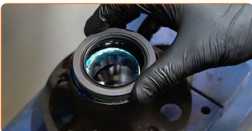
**44** Appliquez du produit sur le siège de fixation de l'ensemble de roulement. Servez-vous d'une graisse multi-usages.
