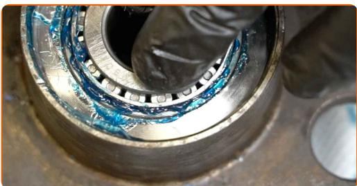
**46** Appliquez du produit sur le siège de fixation de l'ensemble de roulement. Servez-vous d'une graisse multi-usages.
