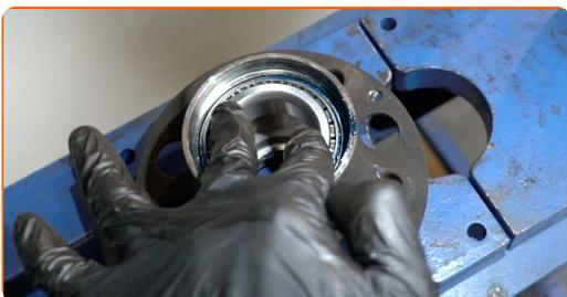
**42** Appliquez du produit sur le siège de fixation de l'ensemble de roulement. Servez-vous d'une graisse multi-usages.
