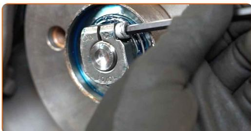
**70** Appliquez du produit sur le palier de moyeu de roue. Servez-vous d'une graisse multi-usages.
