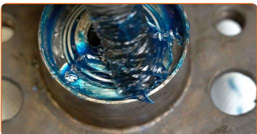
**47** Installez le nouveau moyeu de roue avec un roulement.
