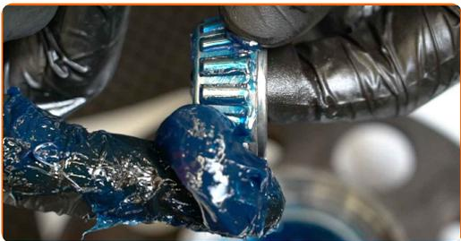
**45** Installez un nouveau roulement de moyeu de roue.
