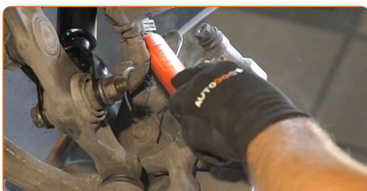
**19** Dévissez l'attache du support d'étrier. Utilisez une douille n° 21. Utilisez un porte-taraud. Utilisez une clé à cliquet.
