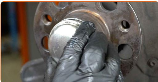
**51** Nettoyez le moyeu. Utilisez une brosse métallique. Traitez la surface de contact. Utilisez de la graisse au cuivre.
