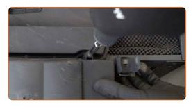
Retirez les couvercles du filtre à air ainsi que les éléments de filtration.
