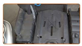
Dévissez les fixations des couvercles du filtre à air. Utilisez la mèche Torx T20. Utilisez une clé à cliquet.
