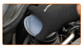
Réinstallez le compartiment du filtre à air.
