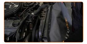
Déverrouillez les clips du couvercle du filtre à air.
