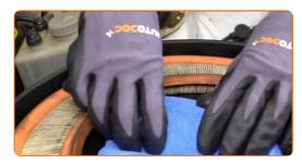
Retirez l'élément filtrant du compartiment du filtre.
