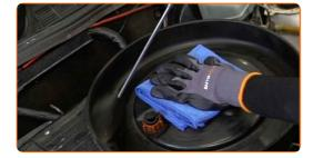
Insérez un nouvel élément filtrant dans le compartiment du filtre.
