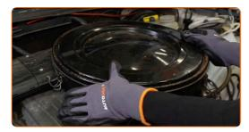
Appuyez sur les clips du couvercle du filtre à air pour les remettre en place.
