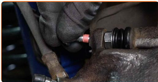
**52** Serrez les fixations de l'étrier de frein. Utilisez une clé mixte de No.15. Utilisez une douille n° 13. Utilisez une clé dynamométrique. Serrez-le jusqu'à 35 Nm.
