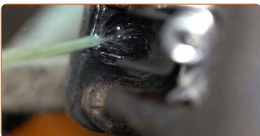
**65** Branchez le connecteur du capteur d'usure de plaquette de frein.
