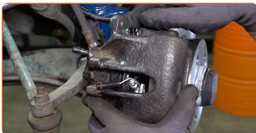
**51** Installez les boulons de fixation.
