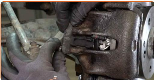
**63** Vissez la fixation du connecteur du capteur d'usure de plaquette de frein. Utilisez une clé mixte de No.10
