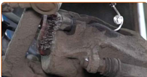
**10** Dévissez la fixation du connecteur du capteur d'usure de plaquette de frein. Utilisez une clé mixte de No.10
