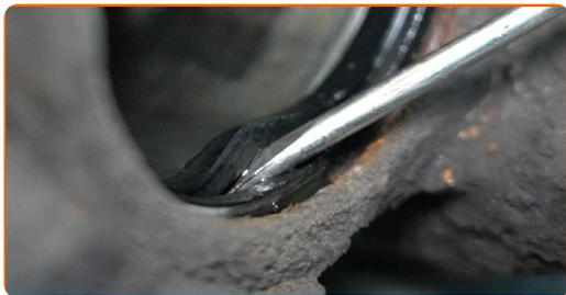
**31** Détachez le vis de purgeur de frein. Utilisez une douille n° 10. Utilisez une clé à cliquet.
