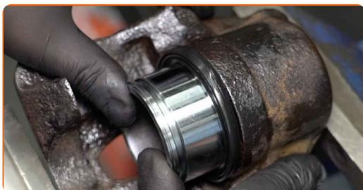
Remplacement : kit de réparation d'étrier de frein – Mercedes W201.
