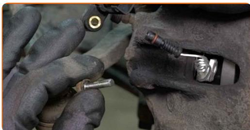
**12** Détachez le connecteur du capteur d'usure de plaquette de frein.
