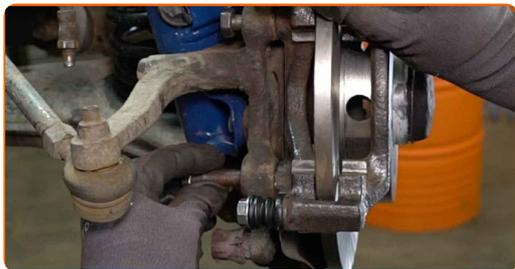
**47** Serrez les fixations du support d'étrier de frein. Utilisez une douille n° 19. Utilisez une clé dynamométrique. Serrez-le jusqu'à 115 Nm.
