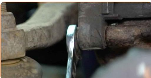
**64** Appliquez du produit sur le bouchon du capteur d'usure des plaquettes de frein. Utilisez de la graisse diélectrique.
