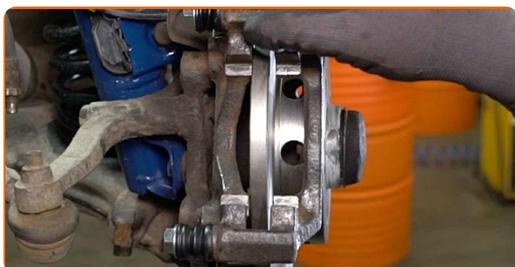
**46** Installez les boulons de fixation.
