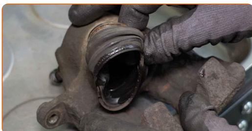
**30** Retirez le joint torique du piston de l'étrier. Utilisez un tournevis plat.
