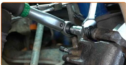
**53** Serrez la fixation reliant la conduite de freinage à l'étrier de frein. Utilisez une clé mixte de No.14 Utilisez une clé dynamométrique. Serrez-le jusqu'à 18 Nm.
