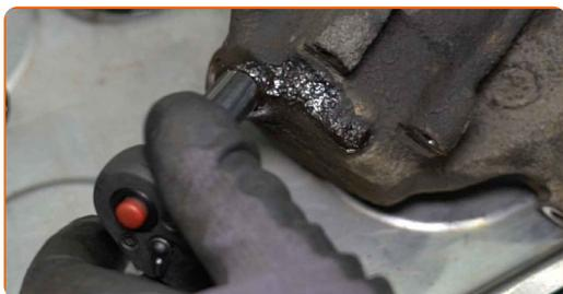
**32** Nettoyez les sièges de montage du piston et des composants connexes. Utilisez une brosse métallique. Servez-vous d'un aérosol nettoyant multi-usages.
