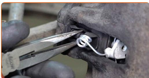
**26** Branchez le faisceau de câbles du témoin d'usure des plaquettes de frein.
