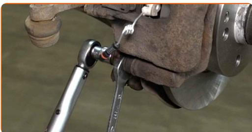
**24** Appliquez du produit sur le bouchon du capteur d'usure des plaquettes de frein. Utilisez de la graisse diélectrique.
