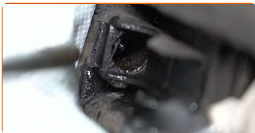
**25** Branchez le connecteur du capteur d'usure de plaquette de frein.
