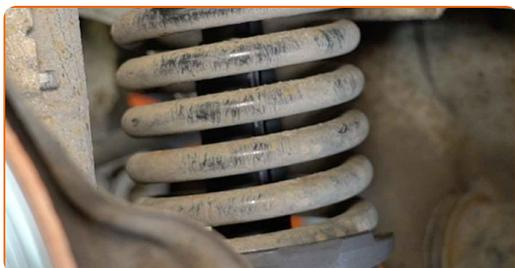
Remplacement : ressort de suspension – Mercedes W201. Les experts d'AUTODOC recommandent :
