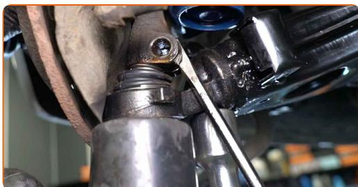
**30** Installez l'écrou de fixation.
