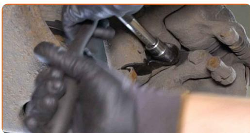
**16** Dévissez la fixation de la tige de piston de la jambe de suspension.
