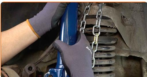
29 Installez les boulons de fixation.
