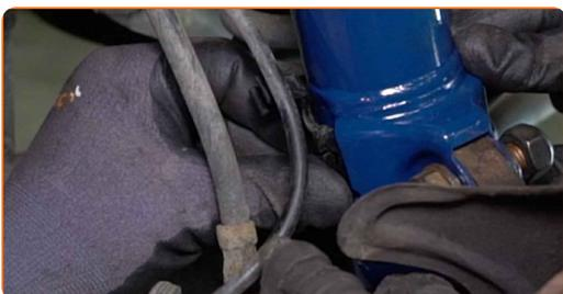
31 Vissez la fixation de la tige de piston de la jambe de suspension.
