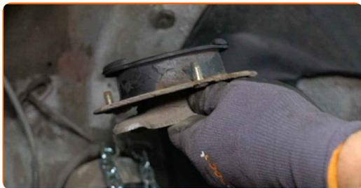
**23** Nettoyez le siège de montage du support de jambe de suspension. Utilisez une brosse métallique. Servez-vous d'un aérosol nettoyant multi-usages.
