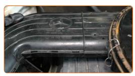
21 Installez les boulons de fixation.
