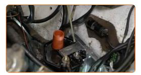
Vissez les bornes de la bobine d'allumage. Utilisez une douille n° 10. Utilisez une clé à cliquet.
