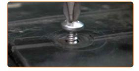
Vissez les fixations du tuyau d'admission. Servez-vous d'un tournevis Phillips. Utilisez une douille n° 10. Utilisez une clé à cliquet.
