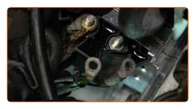
Appliquez du produit sur les bornes de la bobine d'allumage. Utilisez de la graisse diélectrique.
