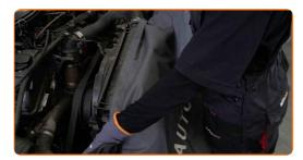
Déconnectez la borne du câble de terre de la batterie. Utilisez une clé mixte de No.10.
