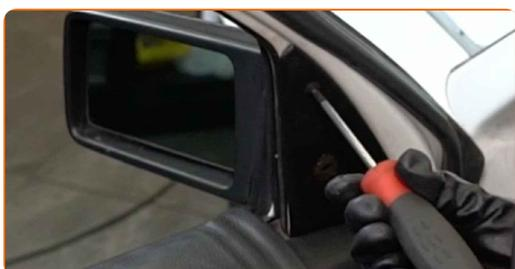
**5** Retirez le cache qui recouvre les fixations du rétroviseur extérieur.
