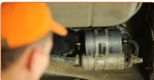
**15** Serrez le collier de serrage du tuyau du filtre à carburant. Utilisez un tournevis plat.
