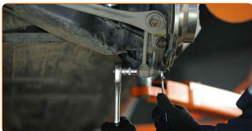
**9** Retirez l'écrou de fixation.
